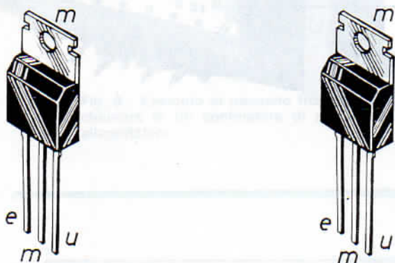
Fig. 14 - Sulla sinistra è riportato l'integrato stabilizzatore 7812 a tensione fissa di 12 Vcc, sulla destra il modello esteriormente uguale 7824, che eroga la tensione fissa di 24 Vcc.
